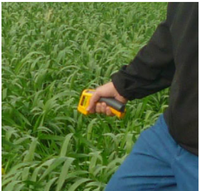
Fig. 10. The infrared thermometer Fluke 62 Mini
